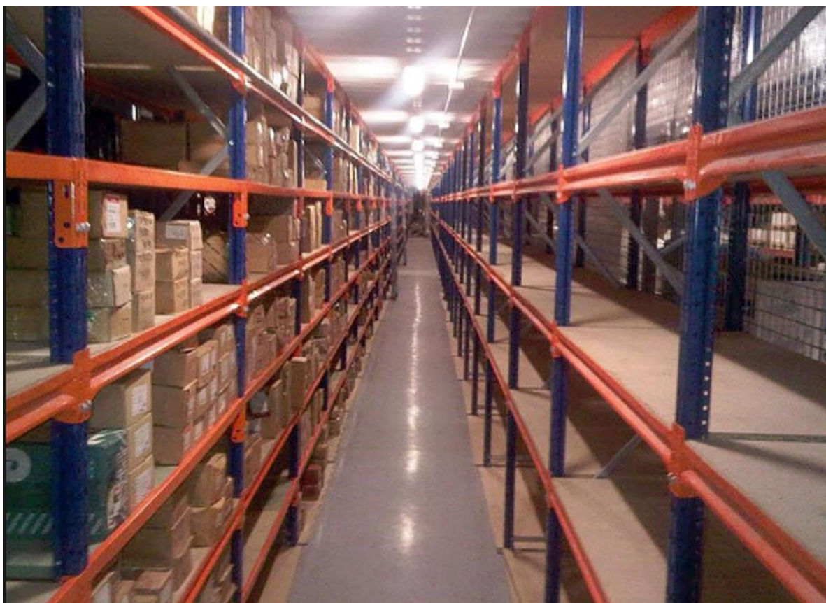
Fig. 27. Modelo de estrutura tipo mini porta-paletes revestidos com madeira
