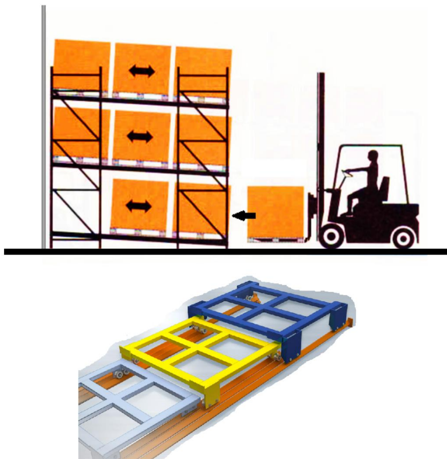
Fig. 13. Modelo de operação push-back e pista de carrinhos com rolamentos
