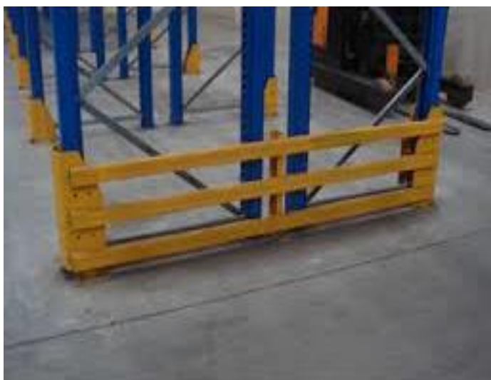
Fig. 4. Modelos de protetor frontal de coluna e protetor lateral duplo
